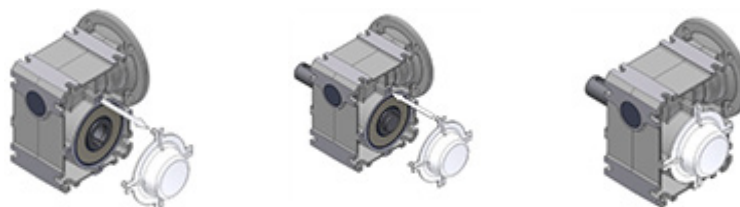
Obr 14: Demontáž a montáž hřídelového krytu
