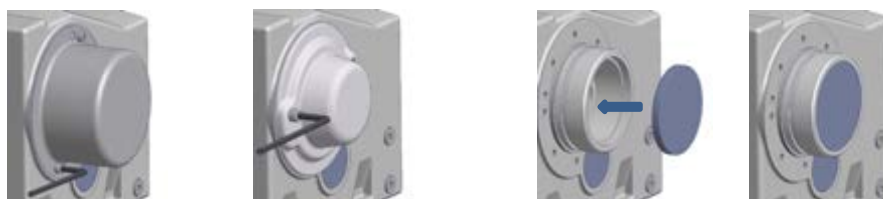
Obr. 13: Montáž hřídelových krytů opce SH, H a H66
